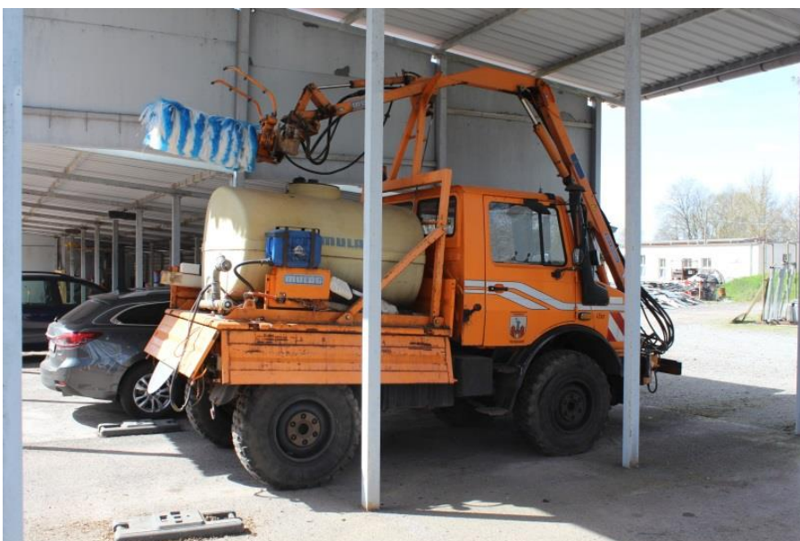
Bild 2 Seitenansicht U 1200 mit Bürstenwaschgerät und Tankaufbau 2000 Liter
