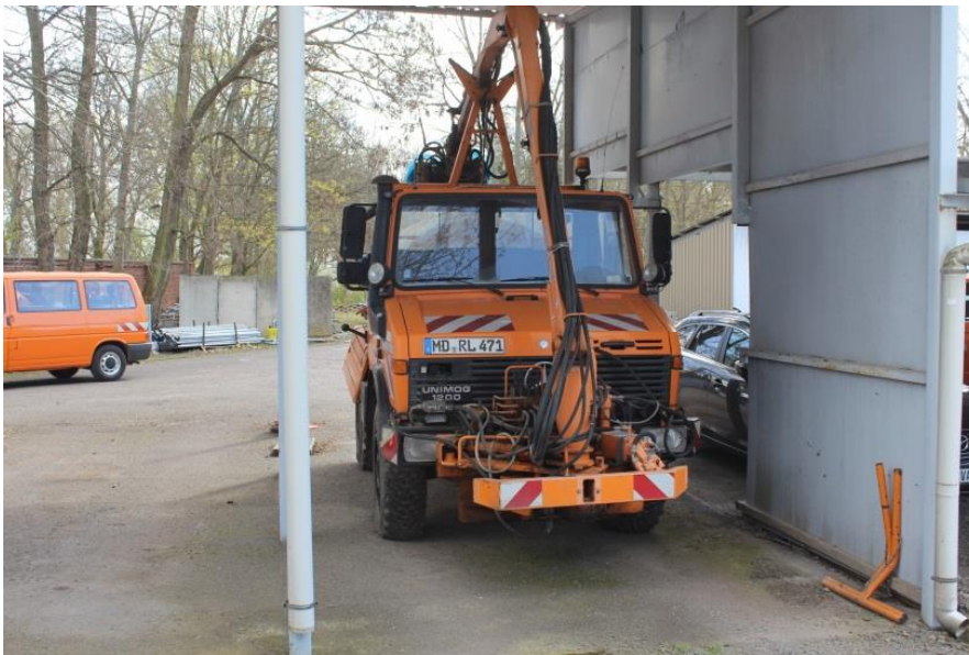
Bild 1 UNIMOG U1200 Baumuster U427 (Trägerfahrzeug) Anlagen Nr.: ANL 00001358 Baujahr 1992 -> 25 Jahre alt mit Vorbau- auslegergerät FME 500 Anlagen-Nr.: ANL00001287 Baujahr 1993 -> 24 Jahre alt
