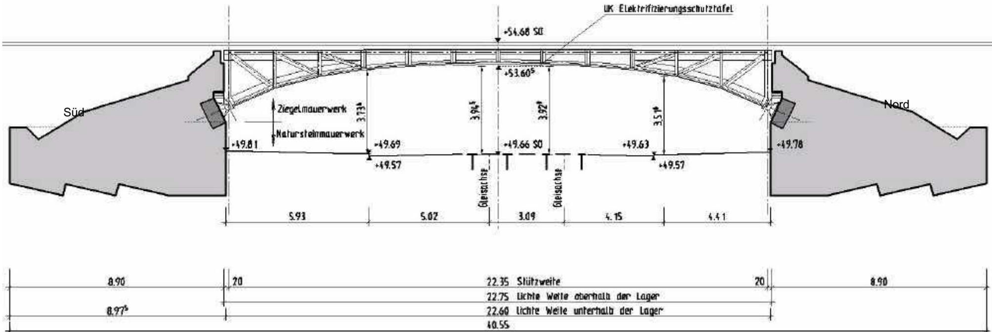
Im Zuge der Planungen wurden die lichten Höhen unter den bestehenden Überbauten in insgesamt 4 Schnitten aufgemessen. Diese Schnitte liegen jeweils unter den am weitesten außenliegenden Bogentragwerken der östlichen und der westlichen Überbaugruppe.
