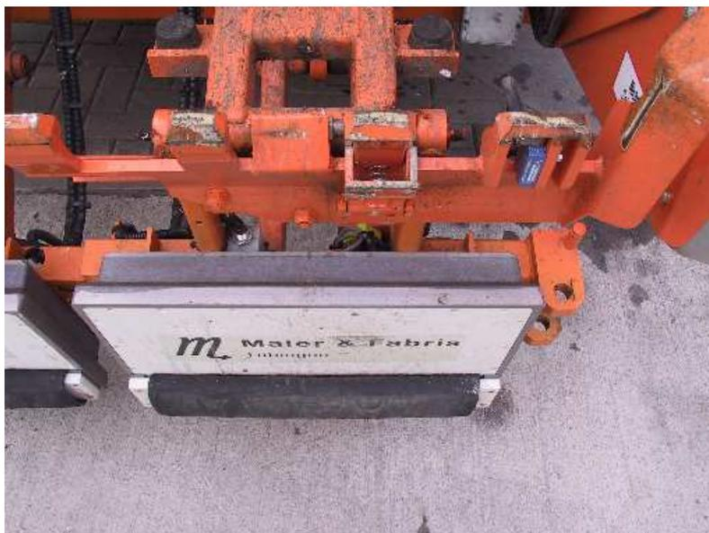
**Abbildung 3** Störstoffdetektor
