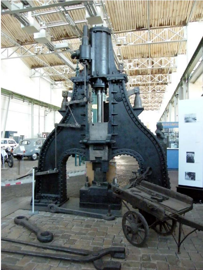
**Abbildung 35: Präsentation eines Dampfhammers**
