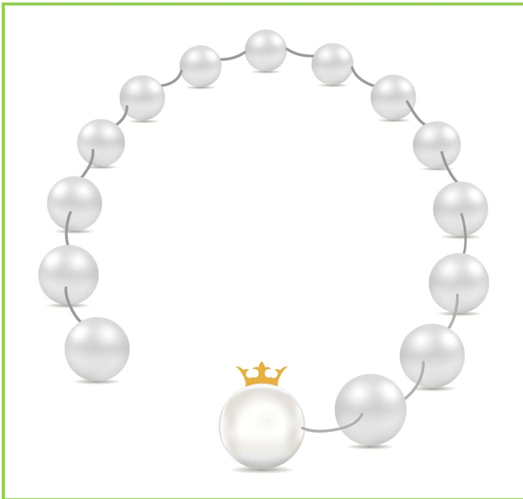
Die „Kaiser-Otto-Kette“ besteht aus insgesamt fünfzehn Edelstahlkugeln, die die Perlen darstellen. Es handelt sich dabei um Hohlkugeln mit circa vier Millimeter Materialstärke. Jede Kugel hat eine Größe von einem Meter Durchmesser.
