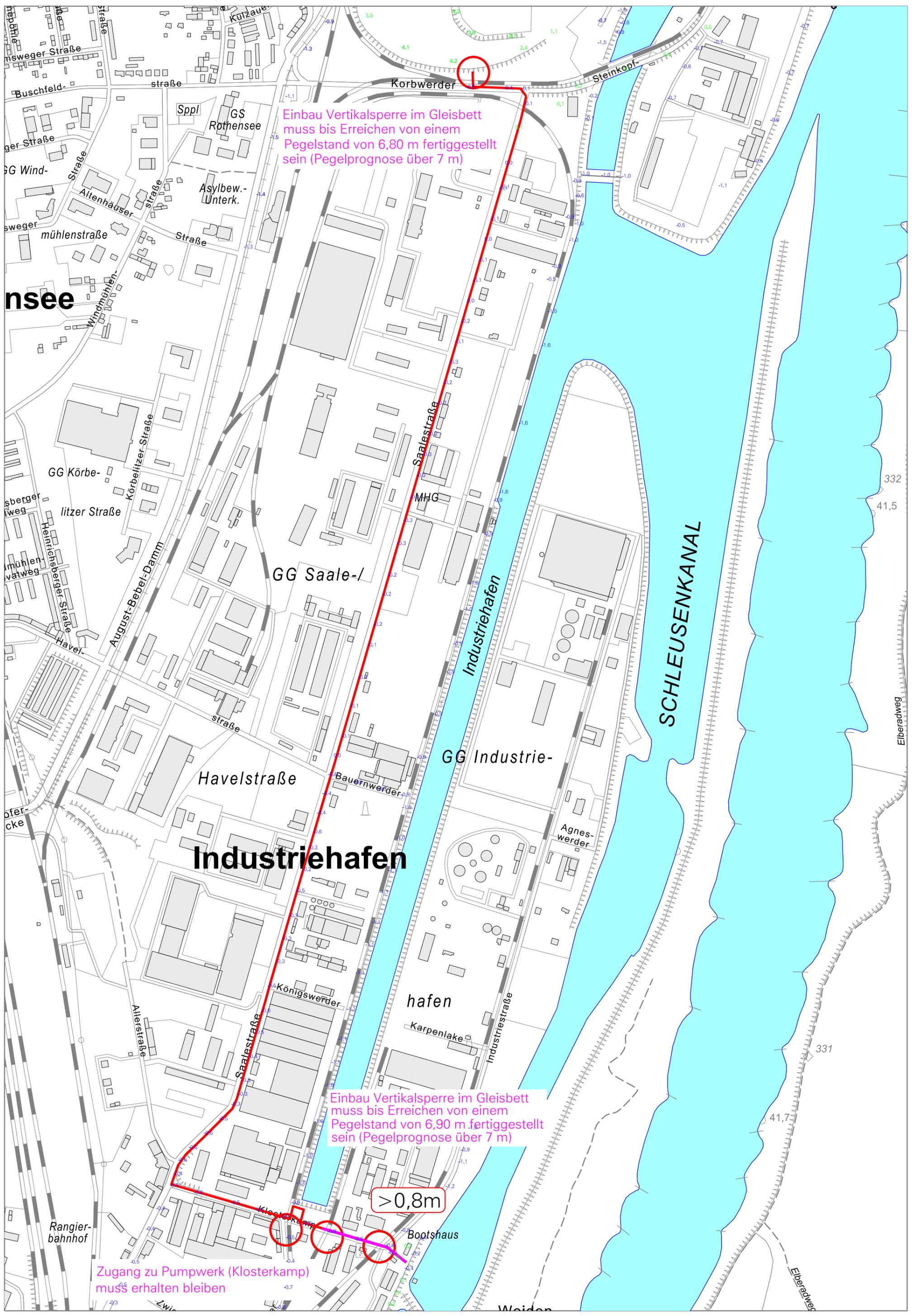
Einbau Vertikalsperre im Gleisbett muss bis Erreichen von einem Pegelstand von 6,80 m fertiggestellt sein (Pegelprognose über 7 m)
