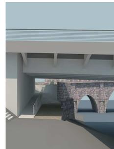
Insgesamt wurde der „tote“ Platz vor dem Widerlager und somit der potentielle Verschmutzungsbereich durch das Heranrücken an die Widerlagerwand reduziert. Gestalterisch wurden auch bei dieser Variante die aufgehenden Bestandsmauern der Bastion in das neue Widerlager integriert (siehe Visualisierung vor). Die im Zuge der Umweltplanung festgestellten Fledermausquartiere innerhalb der Bastion können problemlos in das neue Widerlager
