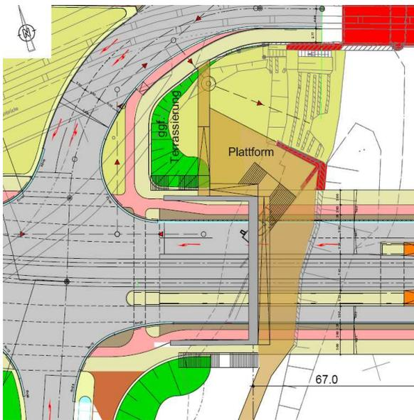
Gestalterisch bleibt nach wie vor die herauspringende Bastionsecke (siehe Foto im Folgenden) das bestimmende Element. Der Geländesprung des unterführten Weges wird mit einer Treppe überwunden. Die barrierefreien Anbindungen des Stadtparkes werden über den darüber liegenden, signalisierten Knotenpunkt und eine an das Widerlager anzubringende Rampe unterhalb der Brücke realisiert.
