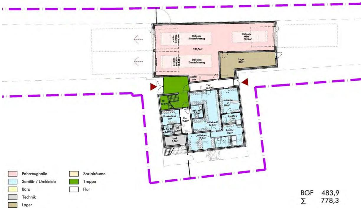
Grundriss Erdgeschoss Variante 2
