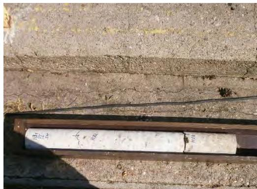
Abb. 11 Probe Kernbohrung
