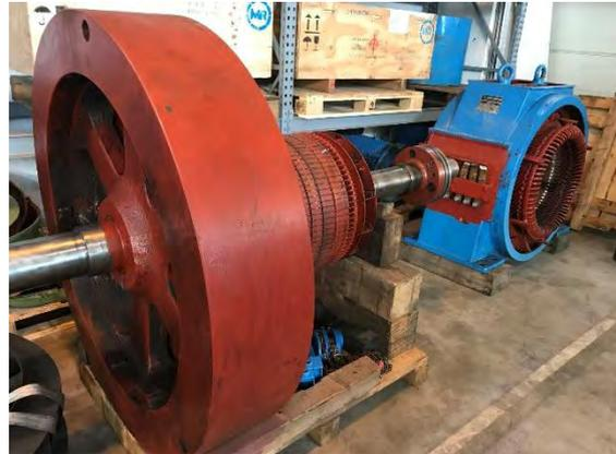
Abb. 25 Drehstromteil Umformersatz
