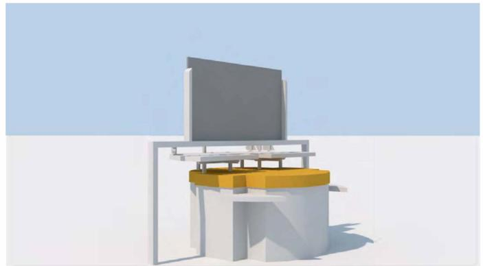
Vorderseite LED Wand 6,4 x 3,6 m - Nutzung des bestehenden Tragwerks
