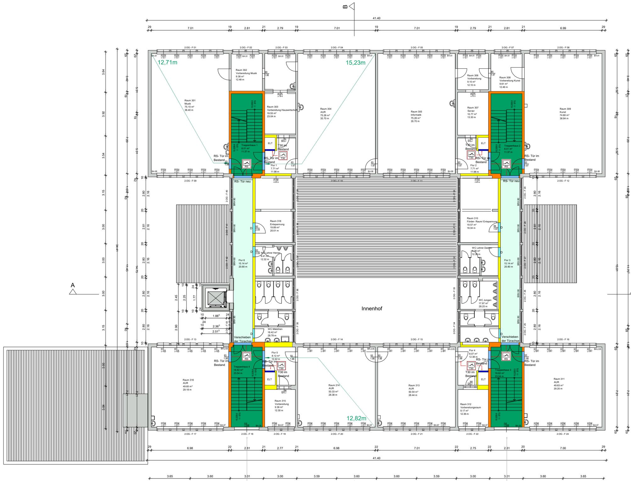
Zur Sicherstellung der Rauchableitung mit Öffnung mindestens 0,5 m<sup>2</sup> freier Querschnitt
