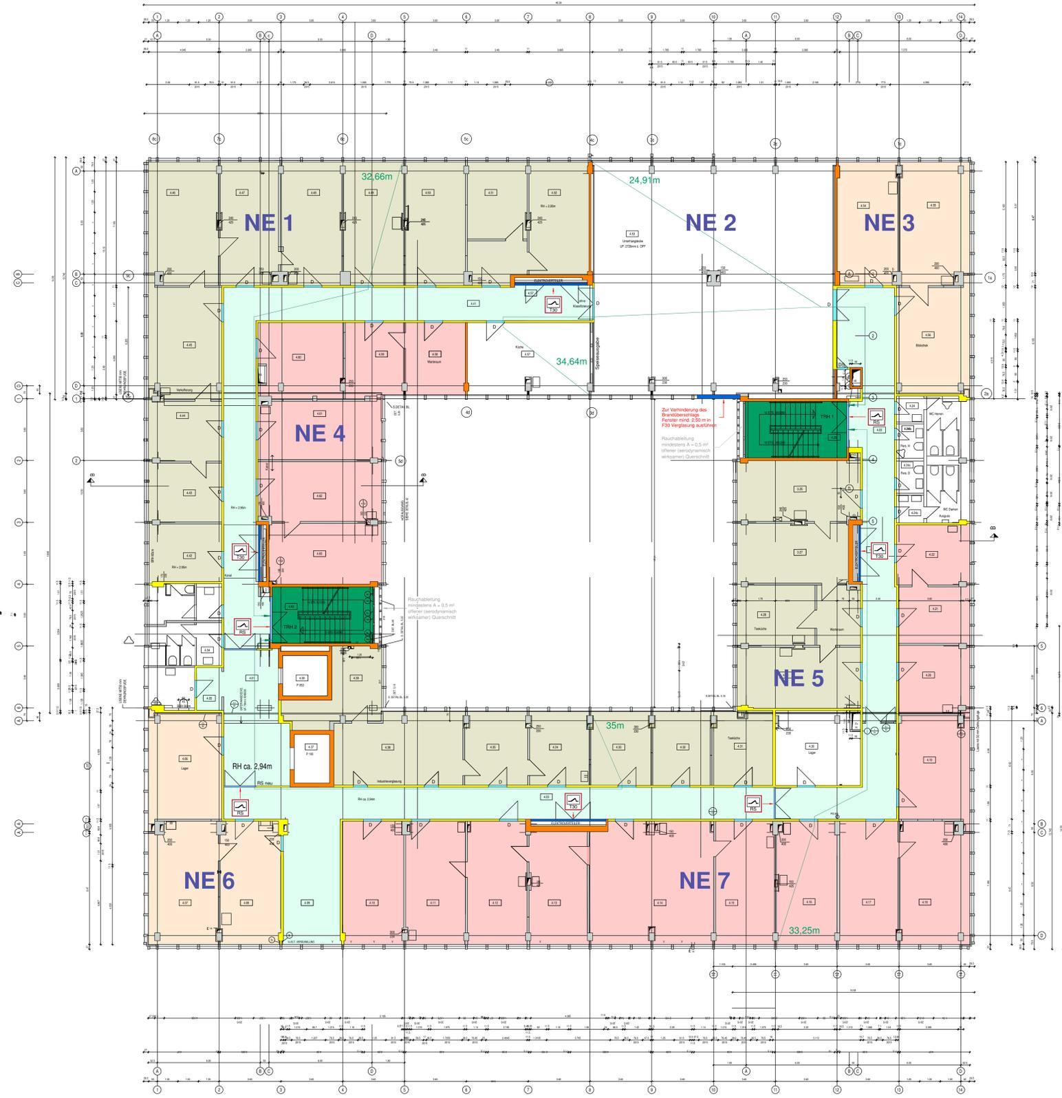
Im Gesundheitsamt sind alle TGA-Installationen, welche durch Geschossdecken geführt werden, vertikal als EI 60 Schacht mit EI 60 - Schachttür (F60, hf - hochfeuerhemmend) oder in der Deckenebene als Raumabschluss in EI 60 (F60, hf - hochfeuerhemmend) brandschutztechnisch auszuführen.
