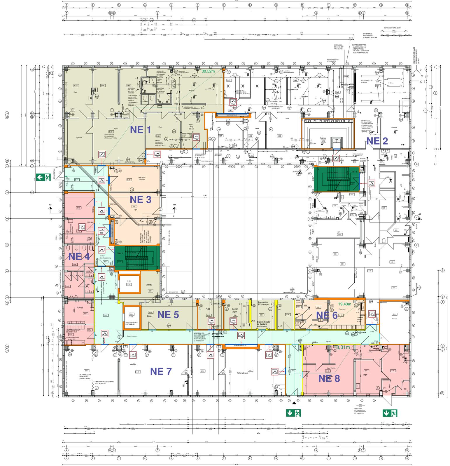
Im Gesundheitsamt sind alle TGA-Installationen, welche durch Keller-Geschossdecke geführt werden, vertikal als EI 60-Schacht (F60, hfh - hochfeuerhemmend) oder in der Deckenebene als Raumschuss in EI 90 (F90, fb - feuerbeständig) brandschutztechnisch auszuführen.
