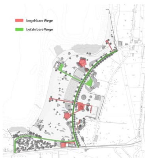
**Der Hauptweg** in Form eines Bogens sowie die westliche Zuwegung ist aus Asphalt herzustellen. Dieser Asphaltweg ist für den Lieferverkehr, die Feuerwehr und die Bewirtschaftung befahrbar. Die Einfassung des Asphaltweges besteht aus zweireihigem sandgelbem Betonpflaster (8x15x15 cm), welche auch als Blindenleitsystem dient.
