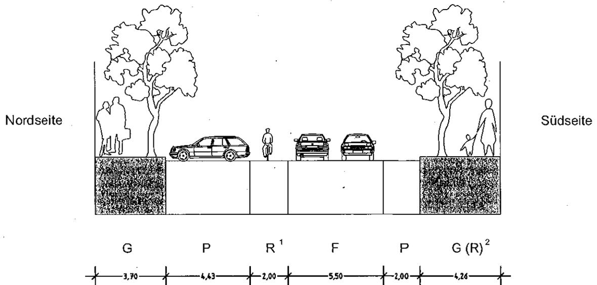
R<sup>1</sup> - Schutzstreifen (Teil der Fahrbahn, darf von Kraftfahrzeugen nur im Bedarfsfall befahren werden)
