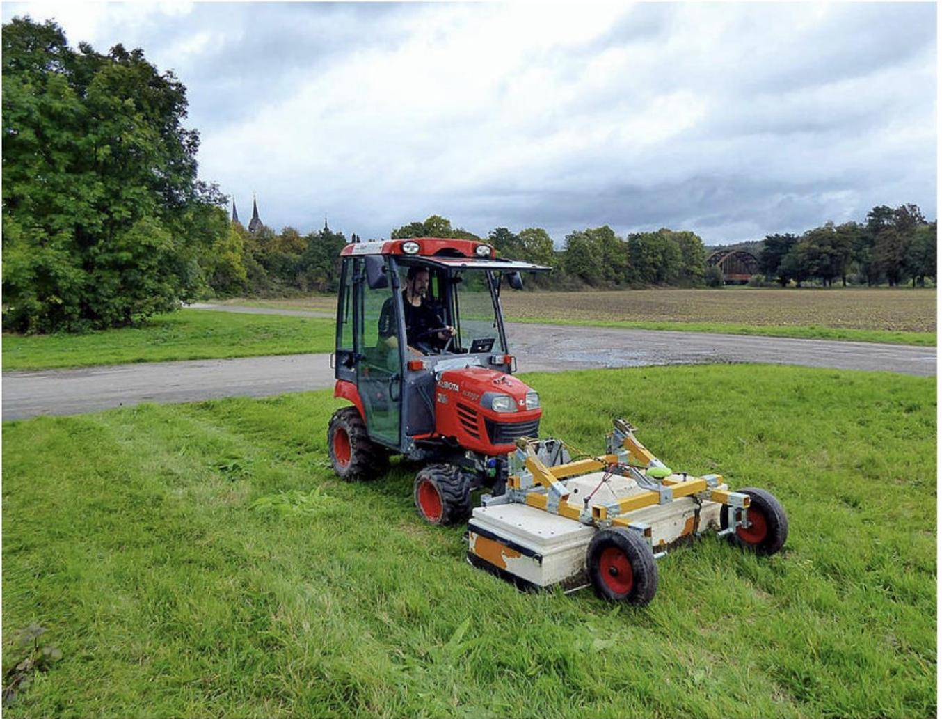
Was aussieht wie ein Rasenmäher ist tatsächlich ein High-Tech-Instrument: Auf der Suche nach mittelalterlichen Mauern senden die Forscher Radarstrahlen in den Boden. Foto: LWL/J. Coolen
