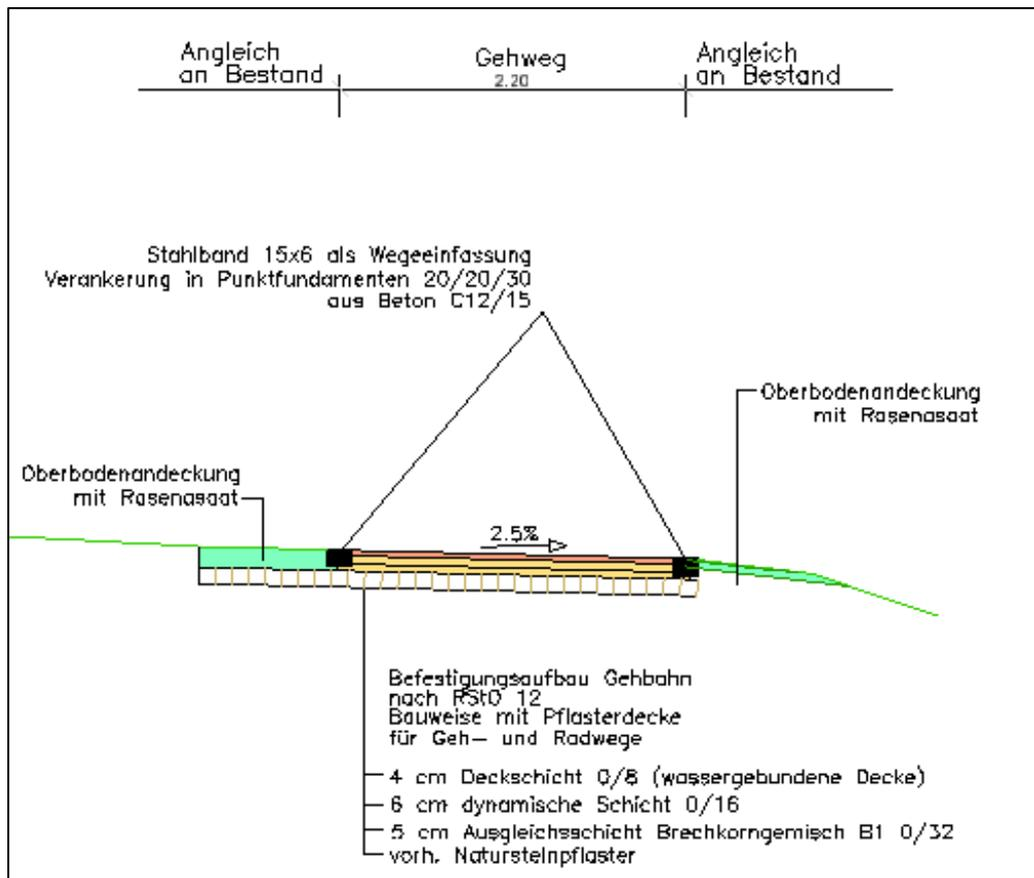
Regelquerschnitt grundhafter Ausbaubereich:
