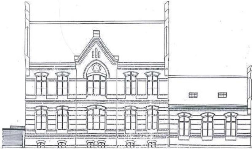
Das Rektorengebäude liegt direkt an der Braunschweiger Straße und wird hofseitig erschlossen. Das Gebäude gliedert sich 2 Teile, einen Nebentrakt mit einem Vollgeschoss und einem Haupttrakt mit 2 Vollgeschossen. Beide Gebäudetrakte sind über den Keller miteinander verbunden.
