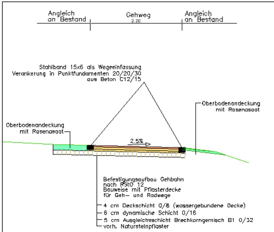
Regelquerschnitt grundhafter Ausbaubereich:
