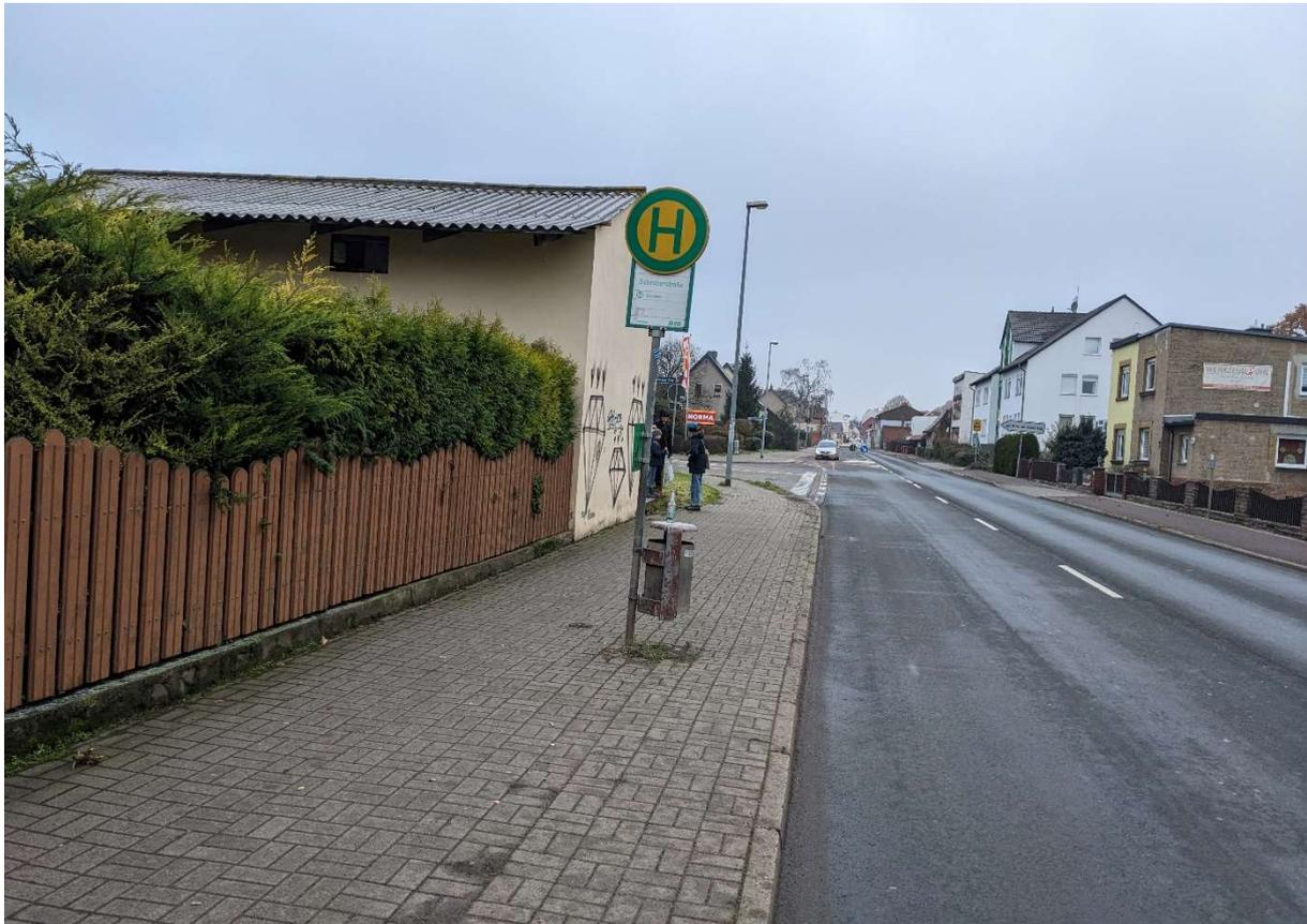
Abb. 7: Gemeinsamer Zweirichtungsrad- und Fußweg endet in Haltestelle und anschließend als Falschfahrt in der Einmündung Werner-von-Siemens-Ring
