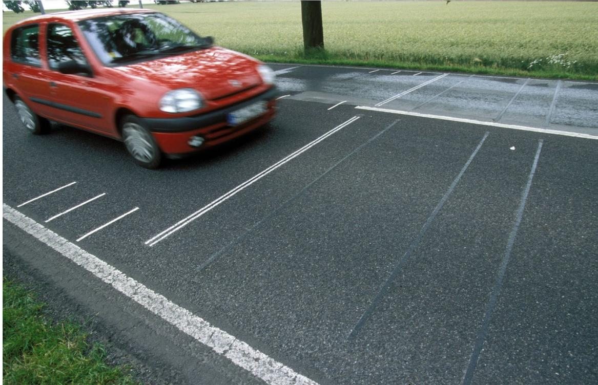
Messung mit Induktionsschleifen
