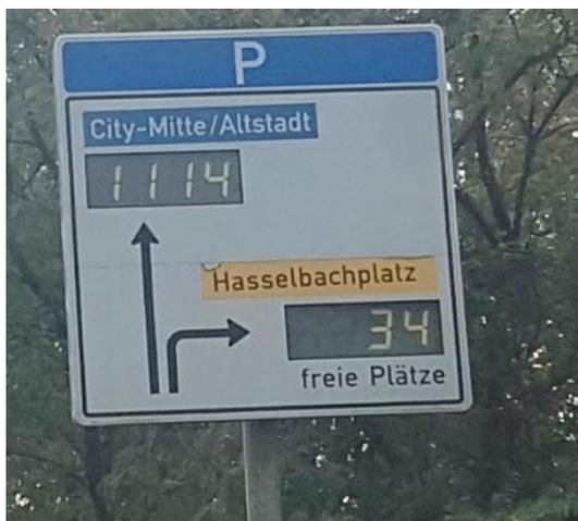
Foto: Bestehender Vorwegweiser in Magdeburg mit dynamischer Restplatzanzeige
