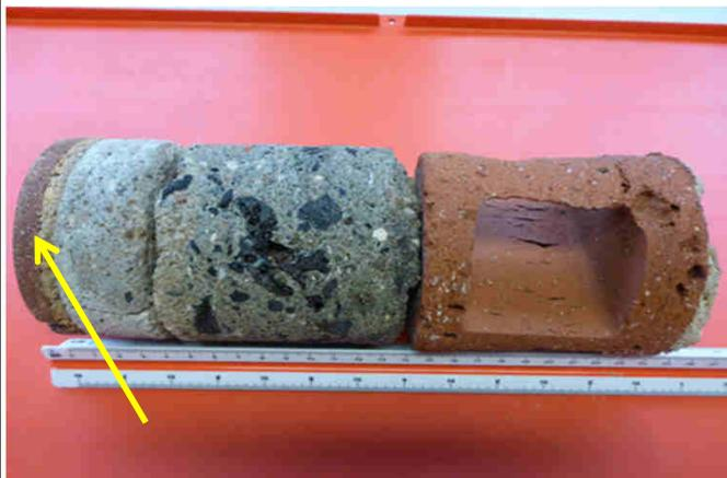
Bild 3: Durchkernter Fußboden
