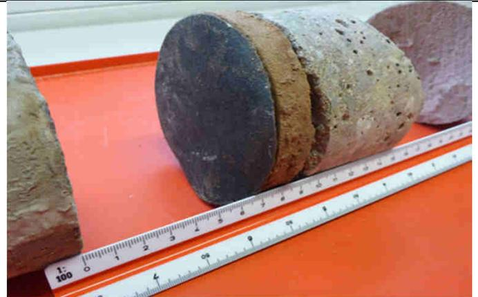
Bild 2: schwarzes Trennpapier unter Estrich
