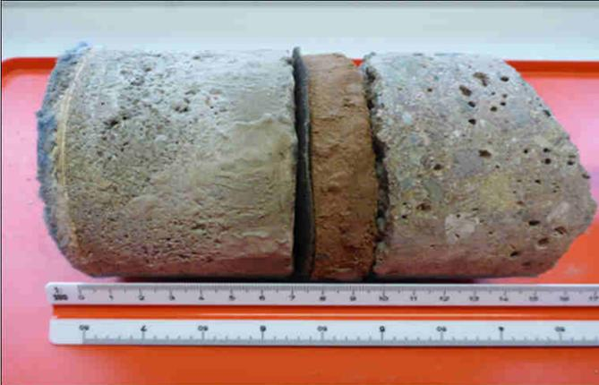
Bild 1: durchkernter Fußboden
