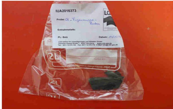
Bild 3: Entnommene Materialprobe der Fugenmasse
