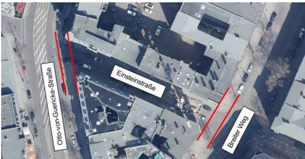
Abbildung 1 Skizze Gehwegverlängerungen (Ausbildung wie an Grundstückszufahrten)
